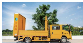
闽高速100K养护作业安全缓冲车
